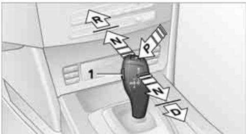
Wählhebel in die gewünschte Richtung tippen, ggf. über einen Druckpunkt. Aus P oder in R gleichzeitig Taste **1** drücken.
