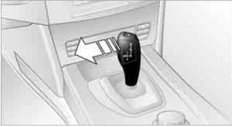
Wählhebel aus der Getriebeposition D nach links in die Schaltgasse M/S bringen: Das Sportprogramm wird aktiviert, in der Instrumentenkombination wird DS angezeigt, beim Sportautomatic-Getriebe\* auch S1 bis S6. Diese Position wird für eine leistungsorientierte Fahrweise empfohlen.
