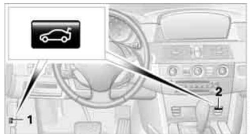
Taste 1 oder Taste 2\* drücken: Die Heckklappe öffnet sich, sofern sie nicht gesichert ist.
