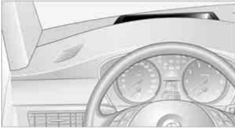
**⚠** Die Abdeckung des Head-Up Displays nur mit einem weichen, nicht kratzenden Lappen oder mit einem Display-Putztuch reinigen, sonst kann es zu Beschädigungen kommen. ◀
