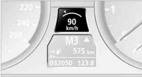
Die gerade gefahrene Geschwindigkeit wird gespeichert. Sie wird im Geschwindigkeitsmesser und kurz in der Instrumentenkombination angezeigt.
