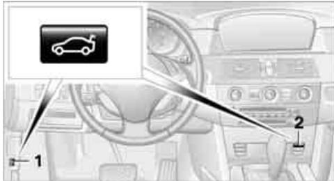
Taste 1 oder Taste 2\* drücken: Die Kofferraumklappe öffnet sich, sofern sie nicht gesichert ist.
