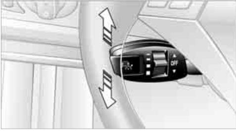
Hebel nach oben oder unten drücken. Die Markierung im Geschwindigkeitsmesser wechselt die Farbe und die Abstandsanzeige erlischt.
