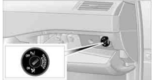
Front- und Seitenairbag für den Beifahrer können mit einem Schlüsselschalter deaktiviert und wieder aktiviert werden. Dieser befindet sich im Handschuhkasten.
