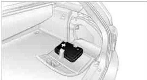
Die Verbandtasche finden Sie in der rechten Seitenverkleidung des Gepäckraums. Vor dem Öffnen der Verkleidung das Spannband\* am hinteren Ende nach hinten ziehen und aushängen.
