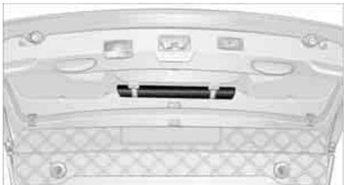
Zwei Schnellverschlüsse lösen und Verkleidung herunterklappen.
