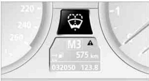
⚠ bedeutet, dass eine Check-Control-Meldung vorliegt. Das Symbol bleibt auch sichtbar, wenn die Check-Control-Meldung nach kurzer Zeit ausgeblendet wurde. Die Warnleuchten und Textmeldungen werden gespeichert und
