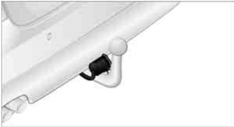
Die Anhängersteckdose befindet sich an der Anhängerkupplung. Abdeckung nach unten klappen.
