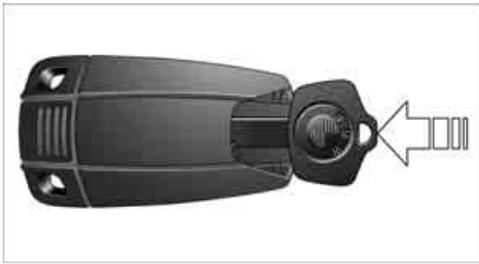
Den Adapter aus der Halterung im Handschuhkasten nehmen und vor Verwendung den Reserveschlüssel in den Adapter schieben.
