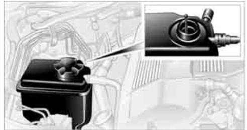
4. Bei Bedarf langsam bis zum korrekten Füllstand auffüllen, nicht überfüllen.
