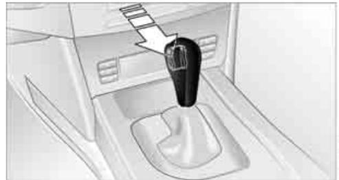
Eine Sperre verhindert das versehentliche Schalten in die Wählhebelpositionen R und P. Um die Sperre aufzuheben, die Taste an der Vorderseite des Wählhebels drücken, siehe Pfeil.
