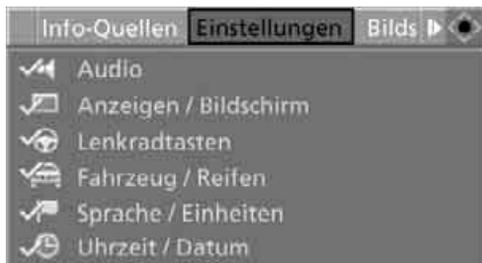
3. Controller drehen, bis „Einstellungen“ ausgewählt ist, und Controller drücken.
