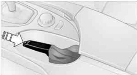
Etwas hochziehen, den Knopf drücken und den Hebel nach unten führen.
