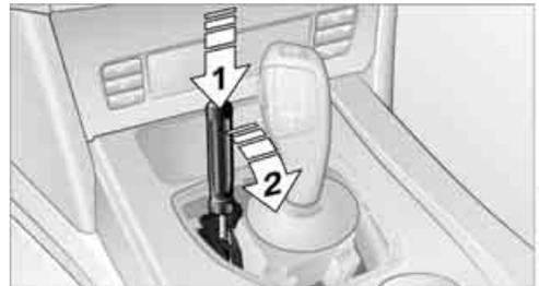
3. Schraubenzieher bis zum hörbaren Einrasten nach hinten ziehen, Pfeil 2, und in der Öffnung stecken lassen. Die Getriebesperre ist entriegelt.
