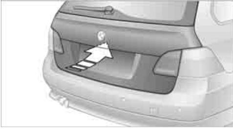
Taste an der Heckklappe oder ca. 1 Sekunde die
