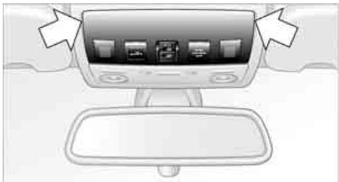
2. Den Innensechskantschlüssel aus der Aufnahme neben dem Bordwerkzeug nehmen und in die vorgesehene Öffnung stecken. Das Dach in die gewünschte Richtung bewegen. Drehrichtung zum Schließen siehe Pfeil.
