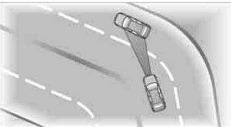
Beim Annähern an eine Kurve kann das System aufgrund der Kurvenkrümmung kurzzeitig auf Fahrzeuge der Nebenspur reagieren. Eine
