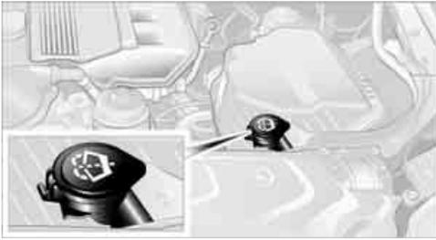
Alle Waschdüsen werden aus einem Behälter versorgt.
