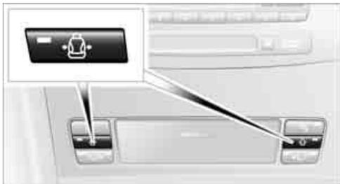
Taste so oft drücken, bis das gewünschte Programm am Control Display angezeigt wird. Die LED in der Taste leuchtet.
