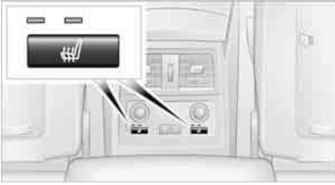
Funktion wie bei der Sitzheizung vorn, zwei Temperaturstufen, ohne Temperaturverteilung.
