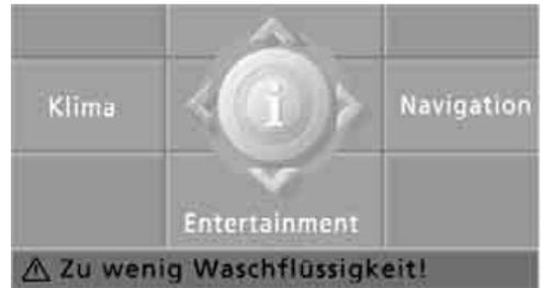
Textmeldungen am unteren Rand des Control Displays erläutern die Bedeutung der eingeblendeten Kontroll- und Warnleuchten.
