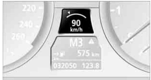
Die gerade gefahrene Geschwindigkeit wird gespeichert. Sie wird im Geschwindigkeitsmesser und kurz in der Instrumentenkombination angezeigt.
