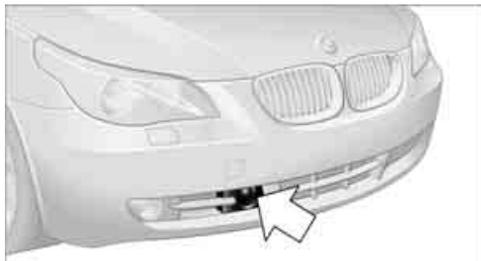
Durch starken Regen, aber auch durch Schmutz, Schnee oder Eis kann die Erkennung vorausfahrender Fahrzeuge eingeschränkt sein. Wenn notwendig, den Radarsensor vorn unter dem Stoßfänger säubern. Dabei Schnee- und Eisschichten besonders sorgfältig entfernen.
