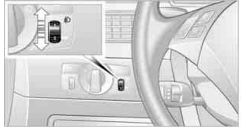
Die Leuchtweite des Abblendlichts muss manuell der Fahrzeugbelastung angepasst werden, sonst wird der Gegenverkehr geblendet.
