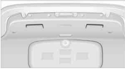
Die Griffmulden an der Innenverkleidung der Kofferraumklappe erleichtern das Herunterziehen.
