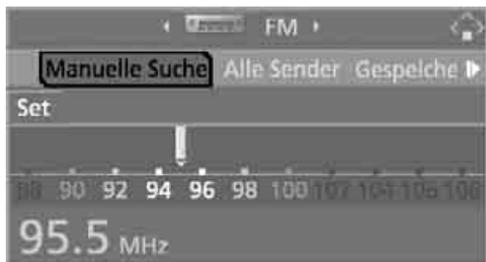
4. Controller drehen, um eine bestimmte Frequenz einzustellen.
