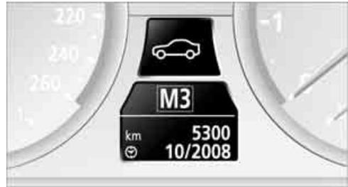
Die verbleibende Fahrstrecke und das Datum für die nächste Wartung werden Ihnen bei eingeschalteter Zündung kurz angezeigt.
