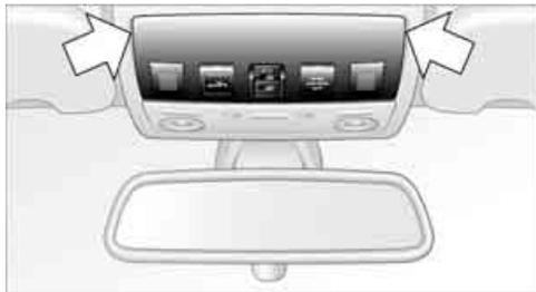
2. Den Innensechskantschlüssel aus dem Bordwerkzeug, siehe Seite 224, in die vorgesehene Öffnung stecken. Das Glasdach in die gewünschte Richtung bewegen. Drehrichtung zum Schließen siehe Pfeil.
