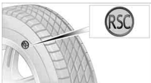
Die Bereifung mit Notlaufeigenschaften erkennen Sie an dem kreisrunden Symbol mit den Buchstaben RSC auf der Seitenwand. Die Bereifung mit Notlaufeigenschaften besteht aus begrenzt selbsttragenden Reifen und besonderen Felgen. Die Verstärkung der Seitenwand sorgt dafür, dass der Reifen bei Druck-
