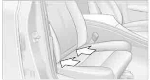
Die Aufnahmen für die ISOFIX Verankerungen befinden sich an den mit Pfeilen gekennzeichneten Stellen im Spalt zwischen Sitz und Lehne.
