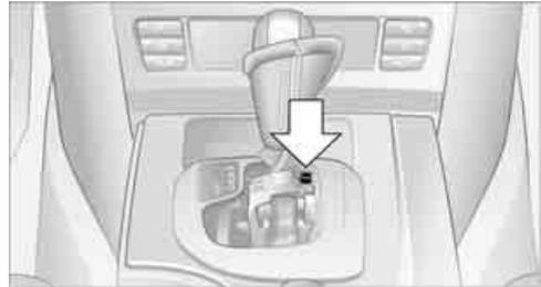
3. Mit dem Schraubenzieher aus dem Bordwerkzeug, siehe Seite 224, den Hebel an der rot markierten Stelle drücken und den Wählhebel in die gewünschte Position bringen.
