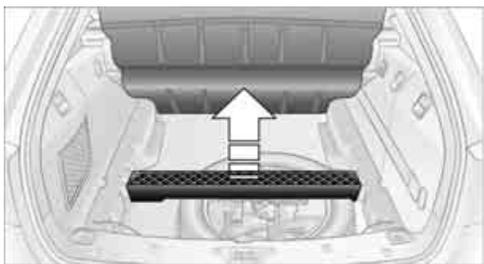
Beim Einbauen der Bodenklappe umgekehrt vorgehen und die Abdeckungen der Scharniere herunterdrücken.
