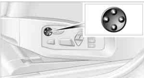
Die Kontur der Rückenlehne lässt sich verändern, sodass die Wölbung der Lendenwirbelsäule, die Lordose, unterstützt wird.
