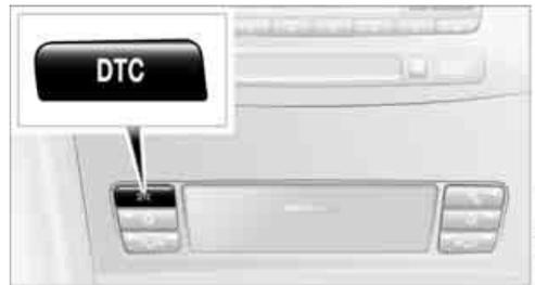
Taste drücken, die Kontrollleuchte DTC in der Instrumentenkombination leuchtet.
