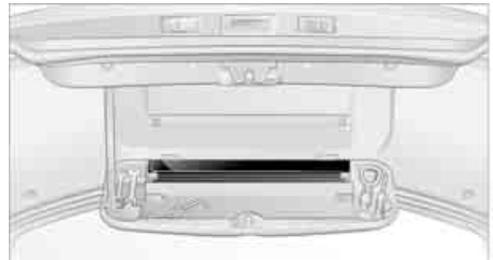
Zum Öffnen die Flügelschraube lösen.
