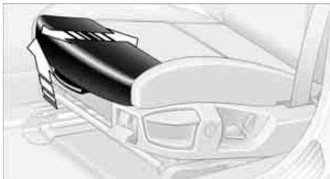
Den Hebel ziehen und die Oberschenkelauflage in Längsrichtung einstellen.
