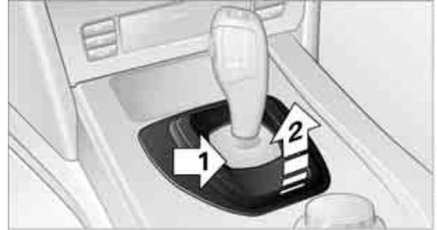
2. Schraubenzieher aus dem Bordwerkzeug, siehe Seite 224, in die Öffnung stecken, Pfeil 1.
