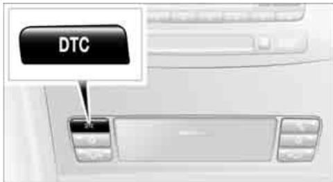
Taste so lange drücken, bis die Kontrollleuchte DSC in der Instrumentenkombination leuchtet, jedoch nicht länger als ca. 10 Sekunden. Dynamische Traktions Control DTC und DSC werden gemeinsam deaktiviert. Stabilisierende und Vortrieb fördernde Eingriffe werden nicht mehr ausgeführt. Außerdem ist der stabilitätsfördernde Eingriff der Aktivlenkung\* deaktiviert, siehe Seite 102.
