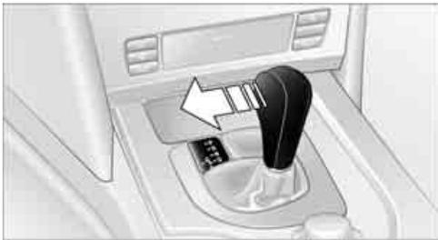
Wählhebel aus der Position D nach links in die Schaltgasse M/S bringen:
